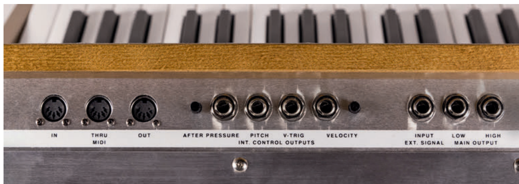
Auf der linken Rückseite befinden sich unter anderem ein MIDI-Trio und verschiedene Steuerausgänge.
