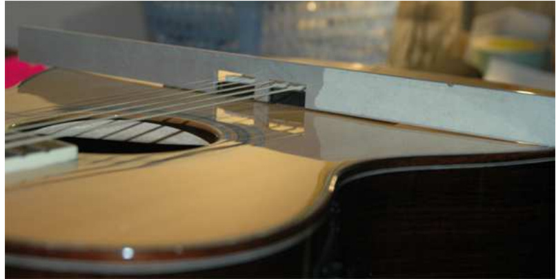
Deutlich sichtbarer Spalt zwischen Lineal und Decke.
